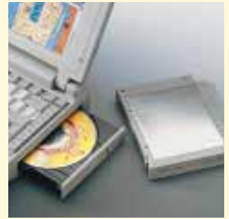
Flexibel: 10fach CD-ROM-Laufwerk oder Diskettenlaufwerk? Beides vorhanden, jederzeit austauschbar.
