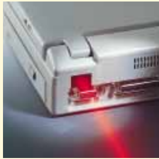
Unabhängig: freie Datenübertragung dank Infrarot-Schnittstelle.
